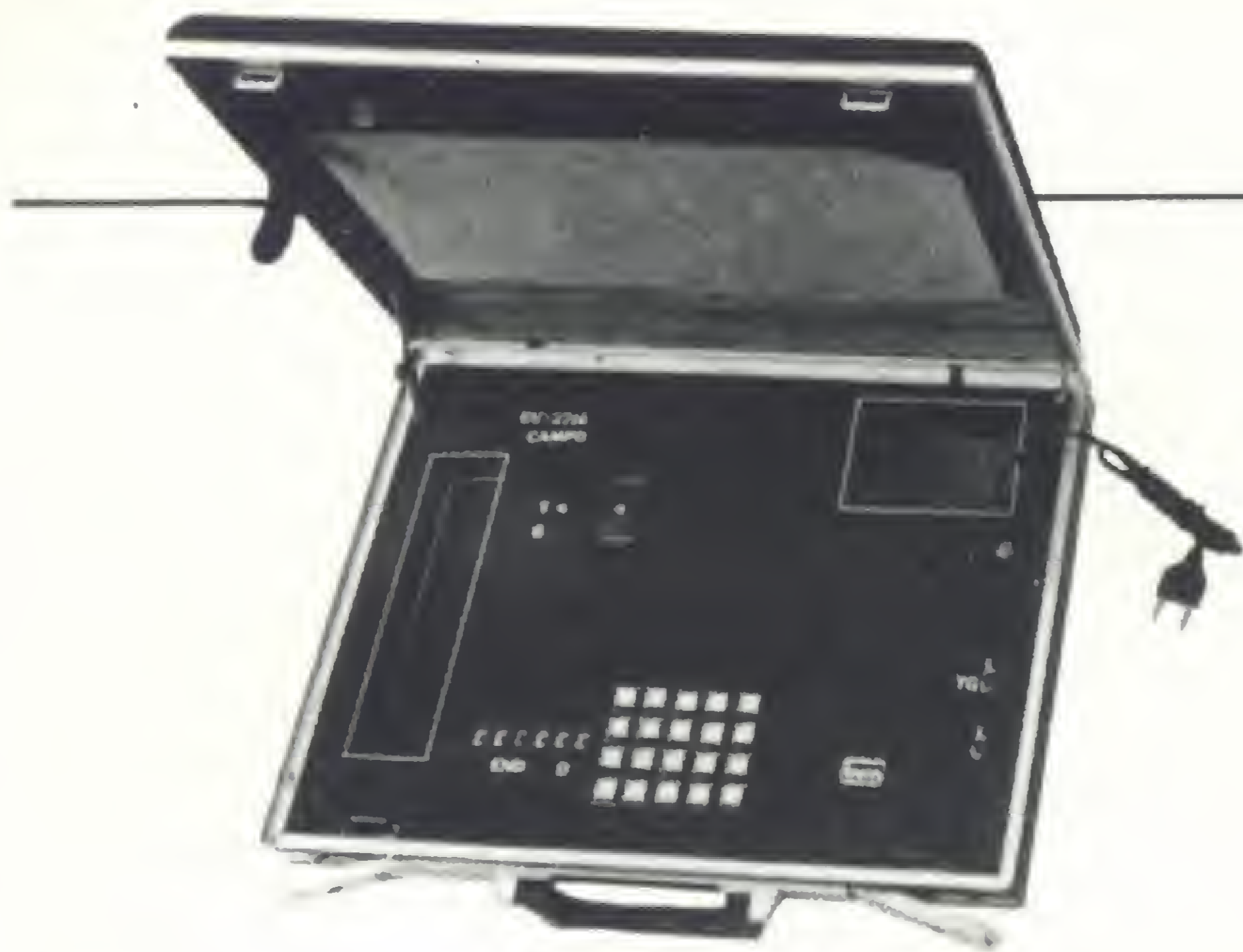
Gravador de EPROM 2716 de campo – permite efetuar gravações em locais remotos.
